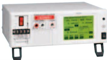
Model : LEAK CURRENT HiTESTER ST5540
